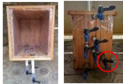
Gambar 5. Cascade Aerator dan Aerator Gelembung
