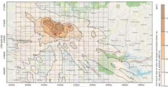
Gambar 7. Model Dispersi Pencemaran Partikulat ( $v = 18$  m/s;  $h = 30$  m; dengan bangunan)
