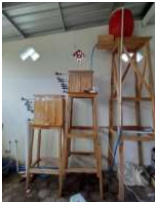
Gambar 4. Rancangan Alat Penelitian Menggunakan Aerator Gelembung dengan Filter
