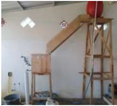
Gambar 2. Rancangan Alat Penelitian Menggunakan Cascade Aerator dengan Filter
