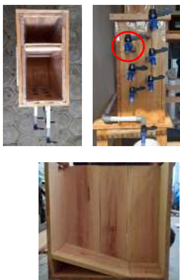
Gambar 6. Bak Sedimentasi Tampak Atas, Tampak Depan dan Tampak Dalam
